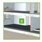
La cave est imperméabilisée sans pour autant devoir déterrer les murs extérieurs. Même en cas d'eau courante, ce type d'étanchement est parfaitement réalisable. L'étanchement contre l'eau sous pression est obtenu par l'application d'un revêtement spécial. Une couche complémentaire d'un mortier d'assainissement perméable à la vapeur est ensuite appliquée.
