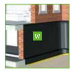
Les joints entre les différents éléments de construction sont indispensables pour absorber les mouvements thermiques. Un étanchement sain des joints offre des joints durablement élastiques, stables et résistants aux UV. On obtient ainsi des mouvements thermiques dans le futur, sans pour autant endommager le bâtiment.
